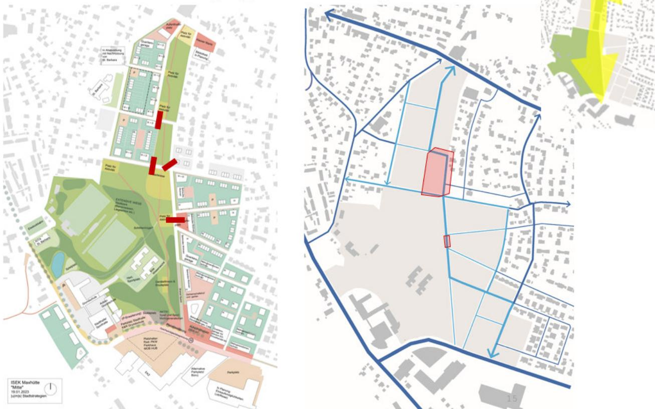
**Bild 18: Netztrennung der Neuen Mitte mit Durchfahrtssperren** (Kartengrundlage: UMS 2023)
