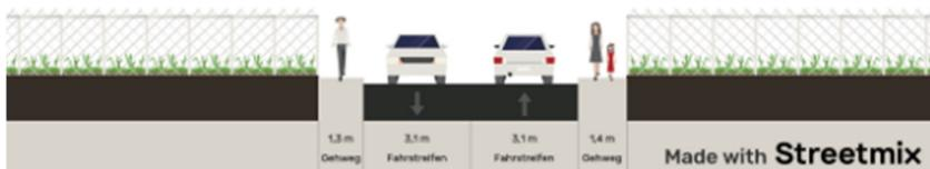
**Bild 65: Querschnitt 8 Bahnhofstraße**
