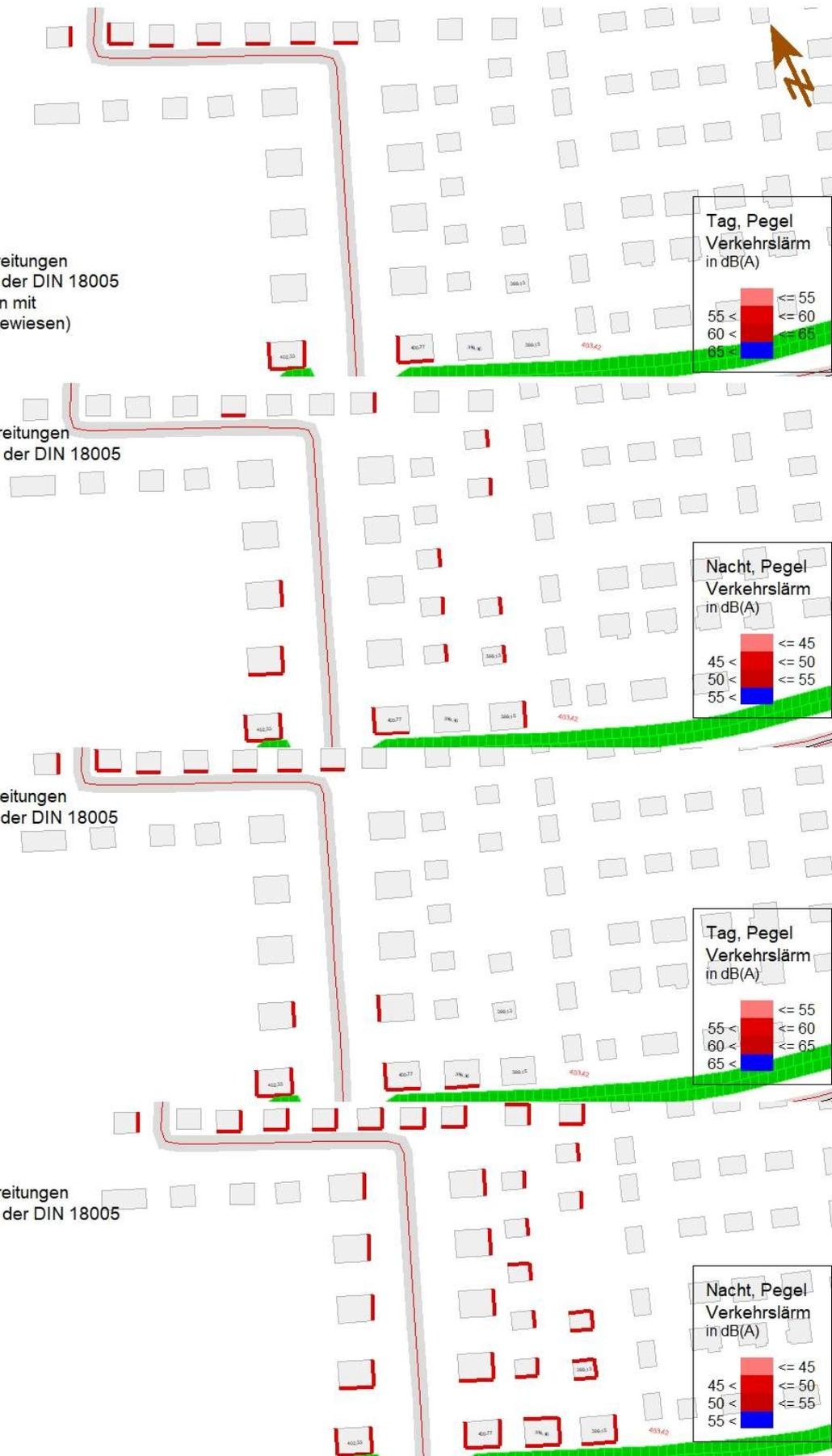
Anlage 1.3: Beurteilungssituation nach DIN 18005 (Fassaden mit Überschreitungen)
