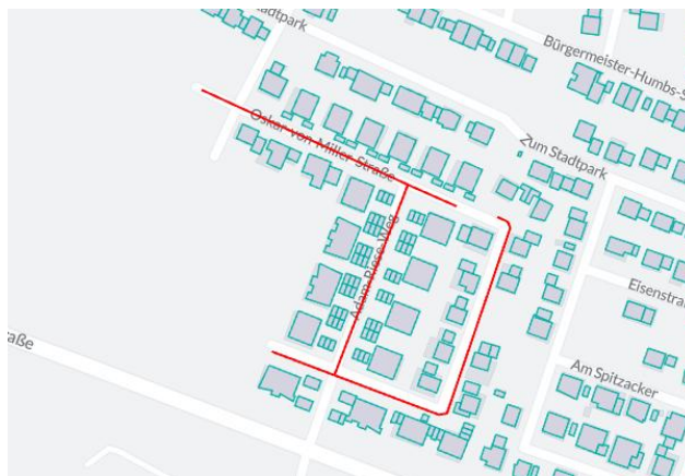
Abbildung 13: Bestehendes Wärmenetz im Baugebiet Ost
